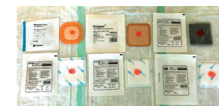
Abb. 5: Testung auf Wäscheschutz – welches Produkt lässt Flüssigkeit durch?
