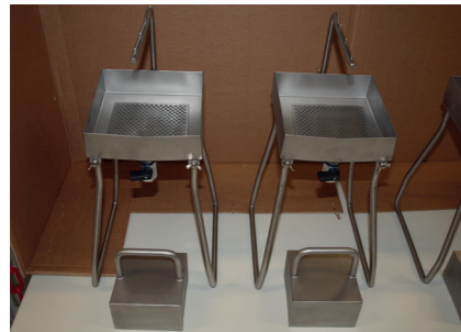
Abb. 2: Das Equipment für den Quellversuch: Edelstahlwannen mit 0,9 % NaCl-Lösung (links). Simulation der Kompression durch 5-kg-Gewicht (rechts).
