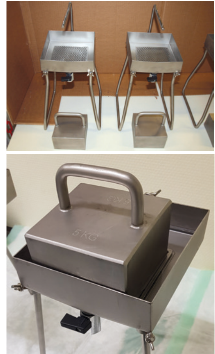
Abb. 2 Das Equipment für den Quellversuch: Edelstahlwannen mit 0,9% NaCl-Lösung (oben). Simulation der Kompression durch 5-kg-Gewicht (unten).
