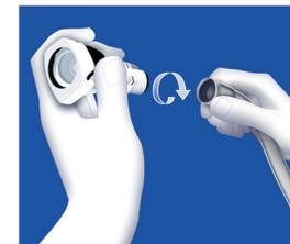
2. Wählen Sie den Schnellkupplungsadapter und bringen Sie diesen am Brauseschlauch an. Überprüfen Sie die Dichtung.
