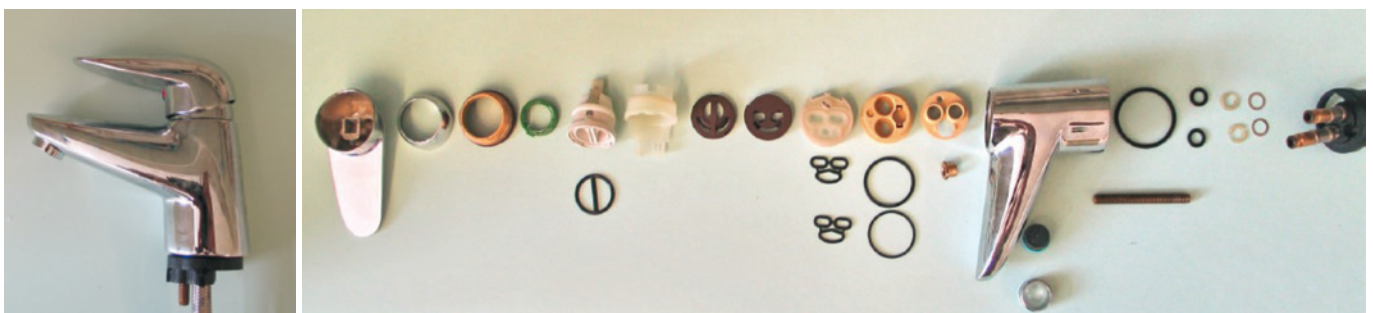
Abbildung 2: Mit P. aeruginosa kontaminierter Wasserhahn (links), bei dem nach Zerlegung auf einer Vielzahl unterschiedlicher Kunststoffteile in Abstrichen P. aeruginosa im Biofilm nachweisbar war.
